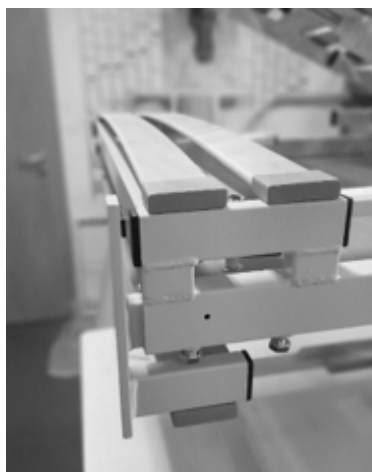
Abbildung 5: Montage der Fußstraverse (200 cm Liegeflächenlänge)
