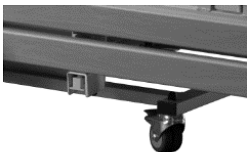
Abbildung 14: Gedrückter Taster/Endschalter durch herabgelassenen Seitenholm
