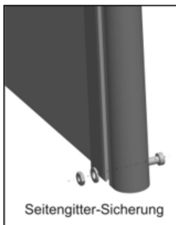
Abbildung 4: Seitengitter-Sicherung – als unterer Anschlag der Holzseitenholme
