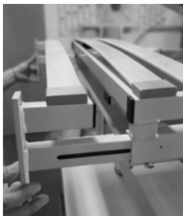
Abbildung 7: Montage der Fußtraverse (220 cm Liegeflächenlänge)
